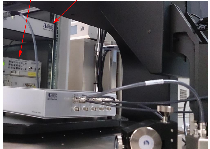
DC Analysator 3023/3022 Control Unit im Rack hinter Prober
